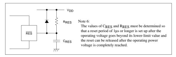
Fig. 8: Reset Circuit
