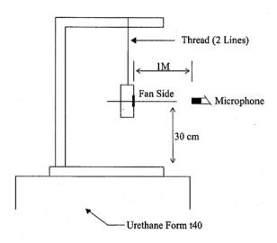
1 METER FROM MICROPHONE TO FAN INTAKE
