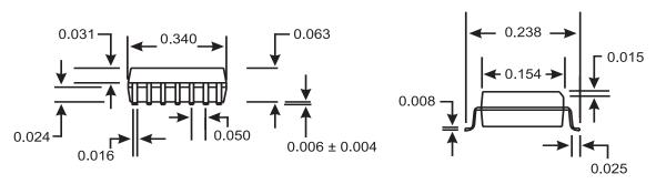
14-Pin 150 mil SOIC Package
