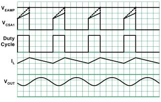
FIGURE 12. PWM OPERATION WAVEFORMS
