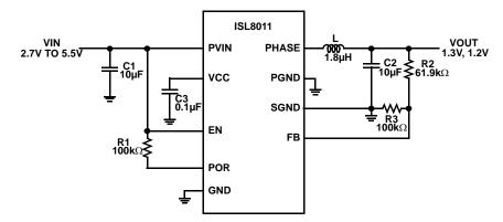
FIGURE 10. TYPICAL APPLICATION FOR ADJUSTABLE VERSION
